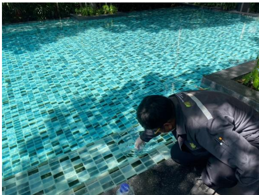
รูปที่ 5-2 แสดงการเก็บตัวอย่างคุณภาพน้ำในสระว่ายน้ำ ของโครงการ พาร์ค รามอินทรา
